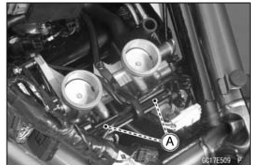
Capteur de température d'eau [A]
